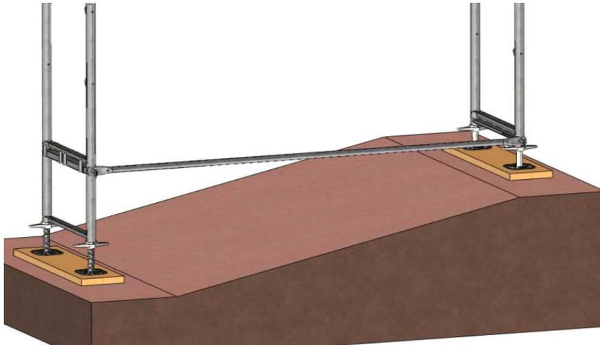
Bild 5: Ausgleichsrahmen mit 0,50 m, 1,00 m bzw. 1,50 m Höhe.
