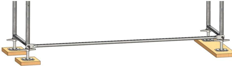
Bild 7: Aufbau des ersten Gerüstfeldes: Längsriegel
