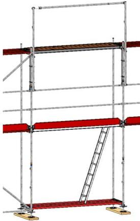
Bild 34: Montiertes MSG nur im Aufstiegsfeld.
