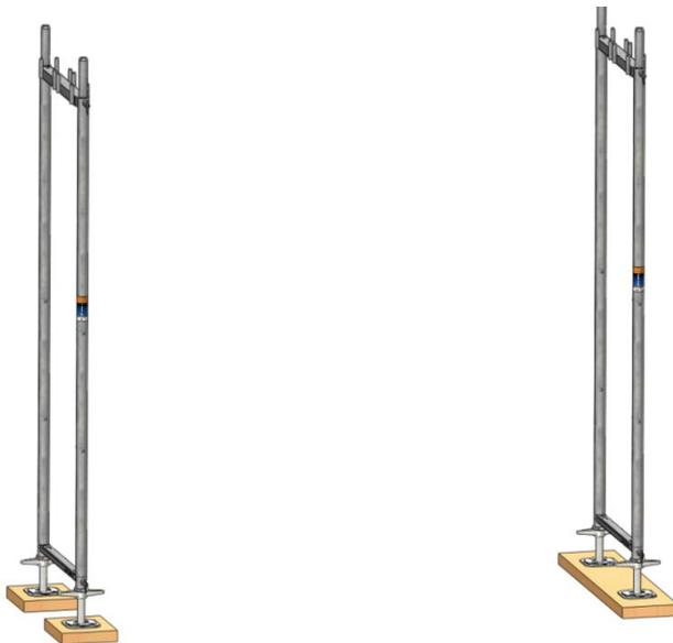
Bild 6: Aufbau des ersten Gerüstfeldes: Vertikalrahmen
