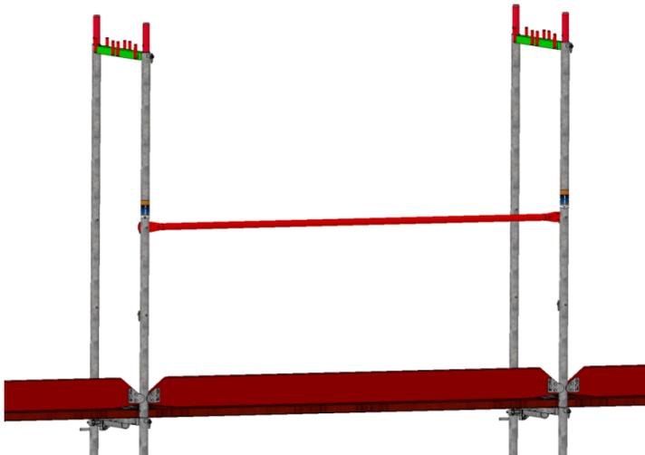
Bild 23: Empfohlene Anschlagpunkte am Vertikalrahmen
