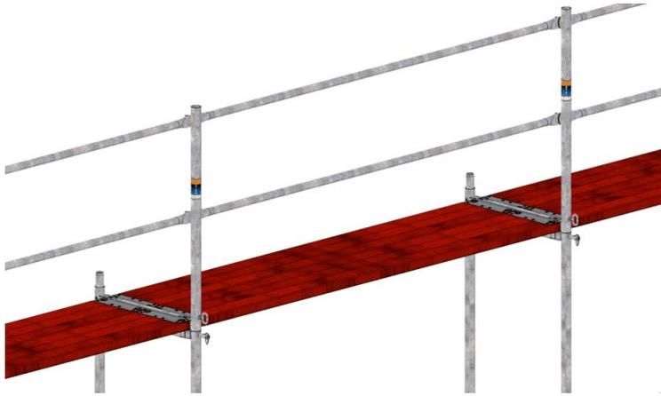
Bild 44: Oberer Abschluss mit Geländerpfosten mit Traversen.
