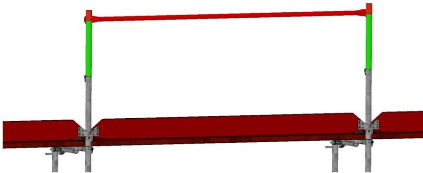
Bild 24: Empfohlene Anschlagpunkte beim oberen Gerüstabschluss
