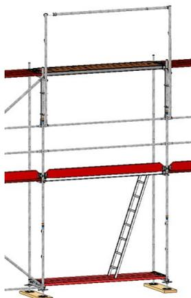
Bild 28: Einhängen des zweiten MSG-Pfosten.
