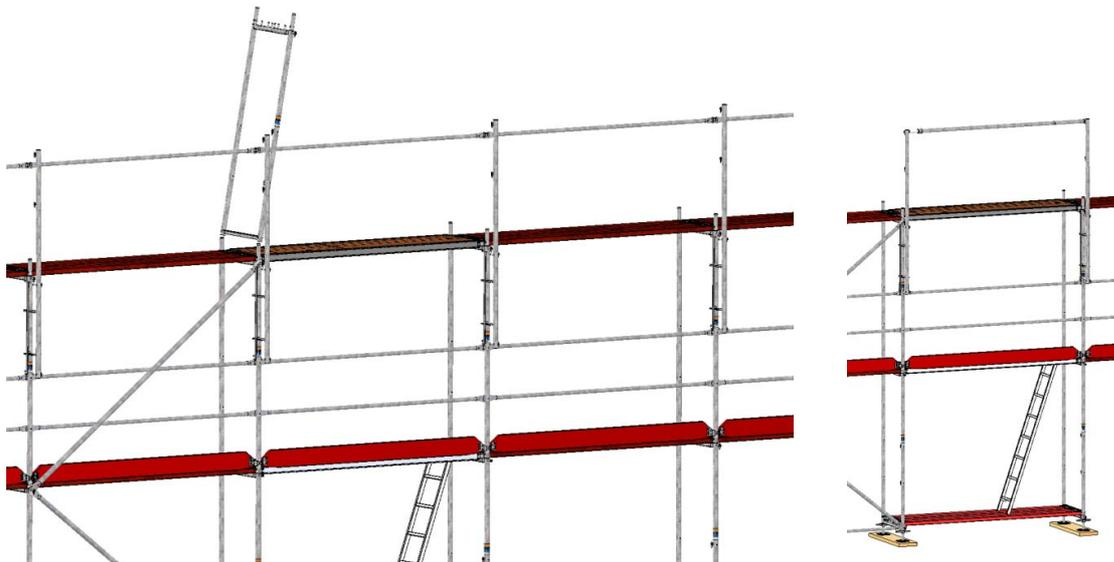
Bild 31: Aufstecken eines Vertikalrahmens.
