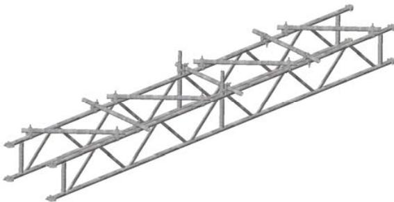
Bild 56: Horizontalaussteifung mit Verband
