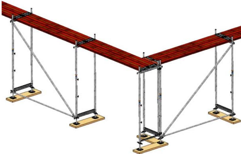
Bild 18: Eckausbildung mit zwei Vertikalrahmen
