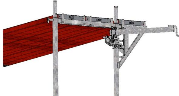
Bild 39: V-Halter, Konfiguration mit Innenkonsolen
