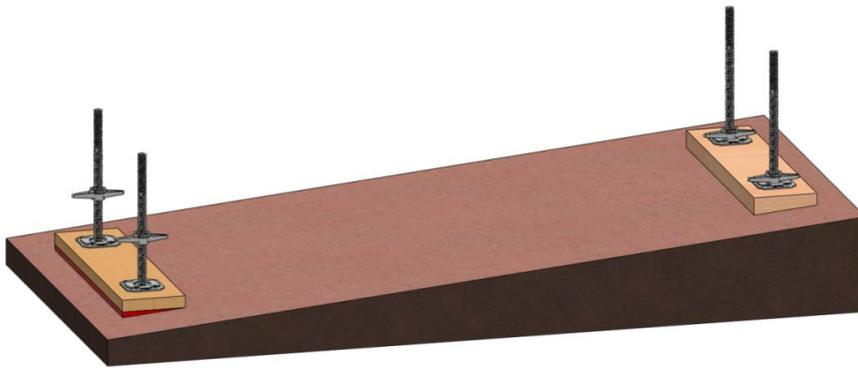
Bild 2: Lastverteilernder Unterbau auf geneigter Fläche
