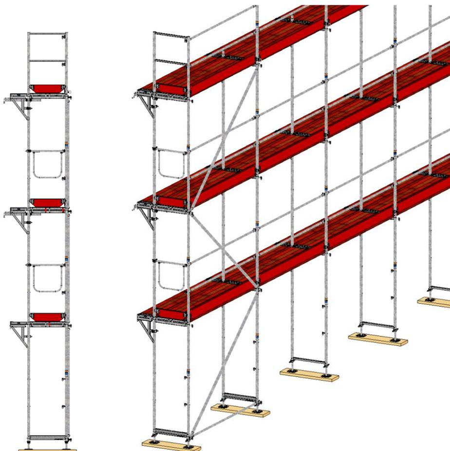
Bild 50: Gerüst mit Verbreiterungskonsolen innen
