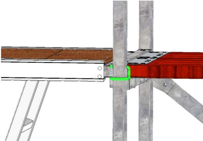
Bild 32: Eingesteckter Fallstecker.
