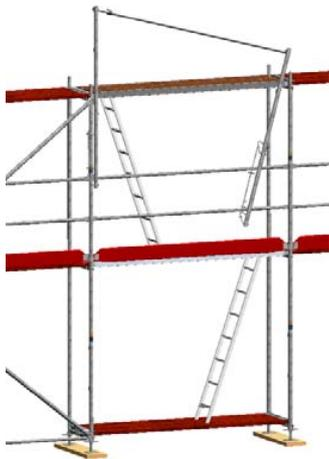
Bild 27: Einhängen des MSG-Geländers und zweiten MSG-Pfostens koppeln.
