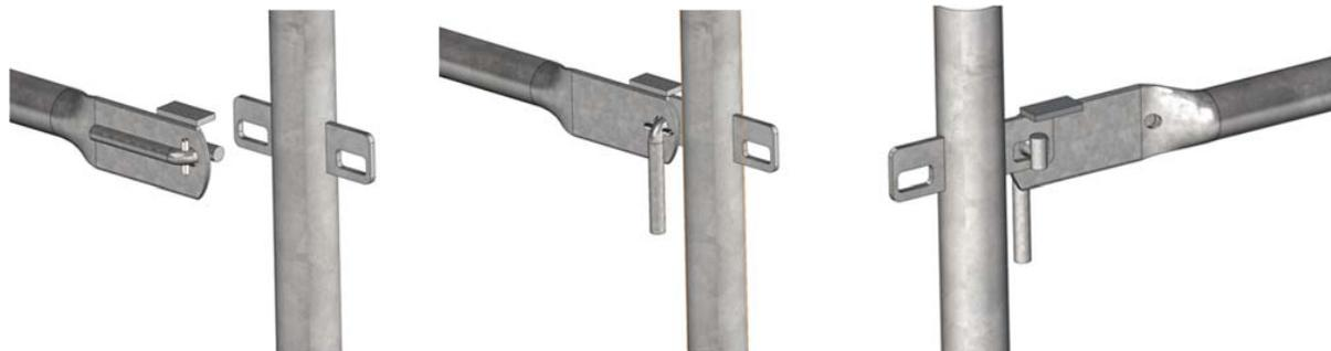
Bild 12: Knebelgeländer montieren und verriegeln.
