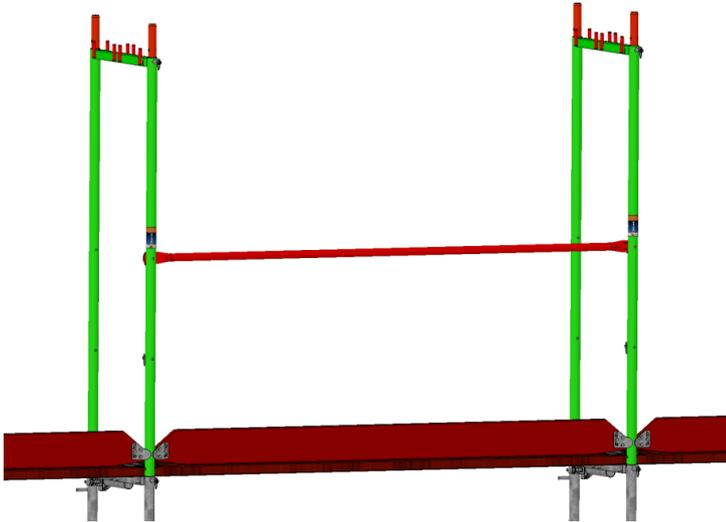
Bild 21: Zulässige Anschlagpunkte für die PSAgA am Vertikalrahmen.
