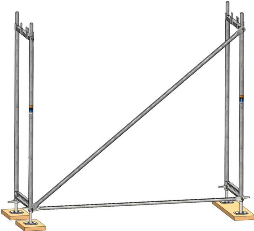
Bild 13: Aufbau des ersten Gerüstfeldes: Vertikaldiagonale
