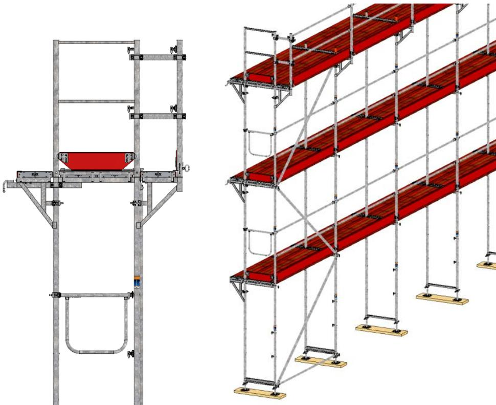
Bild 51: Gerüst mit einbohliger Verbreiterungskonsolen außen und innen
