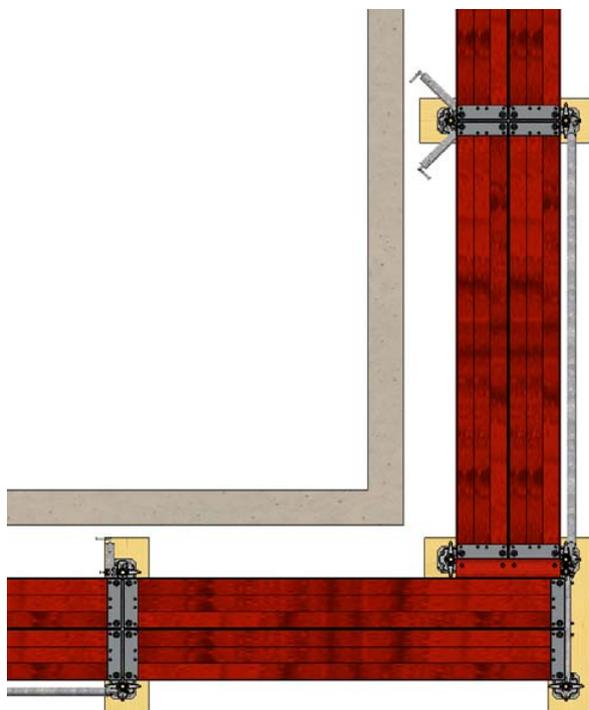
Bild 41: Verankerungen im Eckbereich, Ausführung mit zwei Vertikalrahmen
