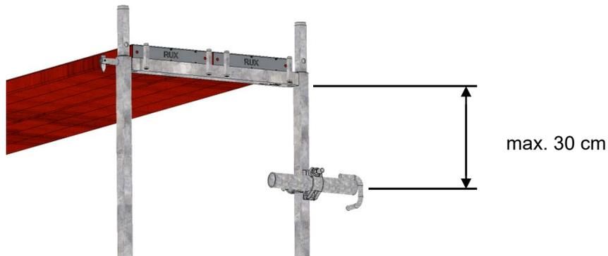
Bild 43: Verankerungen mit abweichender Ankerposition
