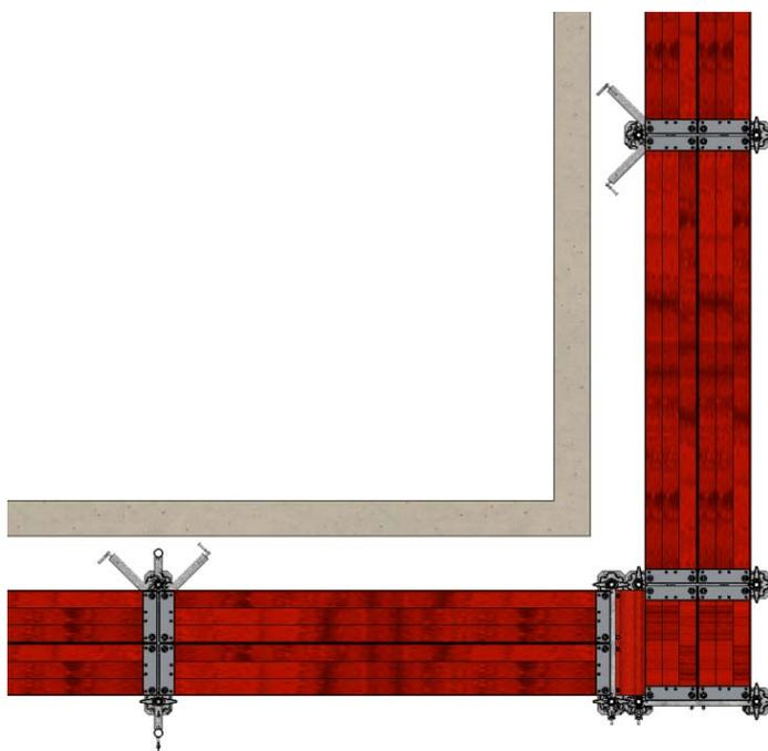
Bild 42: Verankerungen im Eckbereich, Ausführung mit drei Vertikalrahmen
