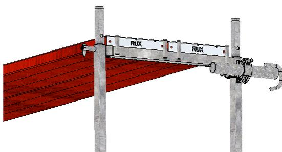
Bild 36: Kurzer Gerüsthalter, Ausführung ohne Konsolen
