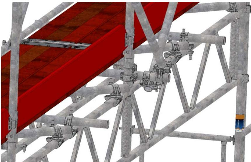
Bild 57: Anschluss der Diagonalen mit Normalkupplungen
