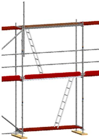
Bild 26: Montage des ersten MSG-Pfostens.
