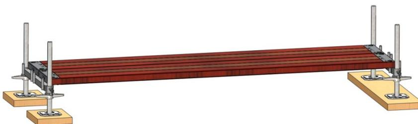
Bild 4: Systembeläge auf Belagtraversen
