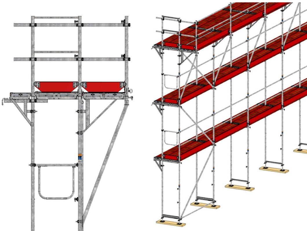
Bild 52: Gerüst mit zweibohliger Verbreiterungskonsolen außen und Abfangstrebe
